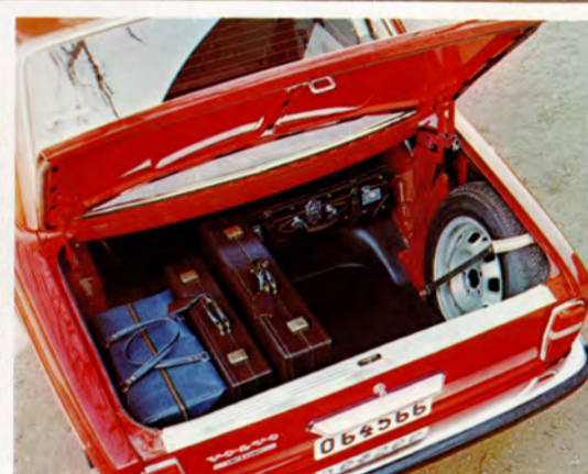
トランク ルーム スペアタイヤはトランクルームの横に立てて収納され、床面はフラットで広く使用できます。
