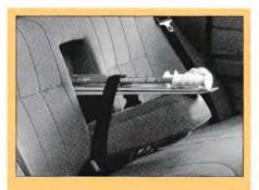
I sedanmodellen finns en genomlastningslucka, bakom det bakre mittarmstödet.
