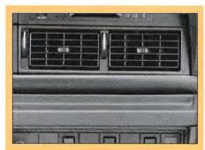
I standardvärmarens mittmunstycken finns möjlighet att steglöst blanda värme och friskluft. Som tillval finns en luftkonditioneringsanläggning, som fr om 1992års modell är 50% effektivare än tidigare.
