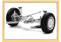
Bakhjulen är förbundna med en stel axel, vilket gör att hjulvinklarna behålls konstanta under alla omständigheter. Bränsletanken är placerad vid bakaxeln
