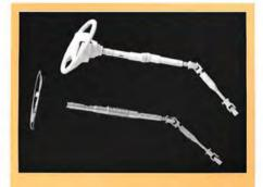
Vid en kollision deformeras ratten och rattstången på ett förutbestämt, progressivt sätt.
