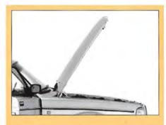
Motorhuven har fjädrar som underlättar öppnandet och håller den i öppet läge.
