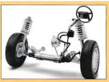
Servostyrning är standardutrustning.
