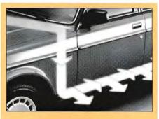
Volvo 240 har en kaross som till största delen är galvaniserad, främre innerskärmar av skyddande plast, ventilerade trösklar och en i övrigt mycket omfattande rostskydds- och ytbehandling.
