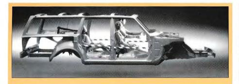
Mycket kraftig stålkonstruktion kring passagerarutrymmet med rundslagningsskydd. Stora deformationszoner fram och bak.
