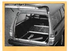
Bakluckan i herrgårdsvagnen har gasfjädrar som underlättar öppnandet och håller den i öppet läge. Luckan har ett handtag både på ut- och insidan.
