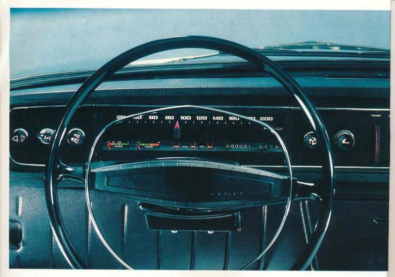
Instrumentpanelen förenar sober elegans med överskådlighet och säkerhet. Instrument och reglage är funktionsriktigt placerade och försedda med symboler. En finess är den flyttbara pilen på hastighetsmätaren som påminnelse vid hastighetsbegränsningar. Vägmätaren är sex-
