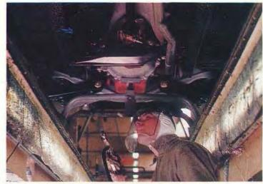
Karossen på Volvo 144 förtjänar verkligen benämningen säkerhetskaross. Runt alla karossöppningar finns extra kraftiga, slutna balkprofiler. Mittstolpen möter inte dörrtröskeln vinkelrätt utan har en »förstyvande fot». De längsgående sidobalkarna fram och bak är utförda i ett stycke för maximal styvhet. Fönsterstolparna har kunnat göras mycket smala och ändå synnerligen starka tack vare inbyggda för-
