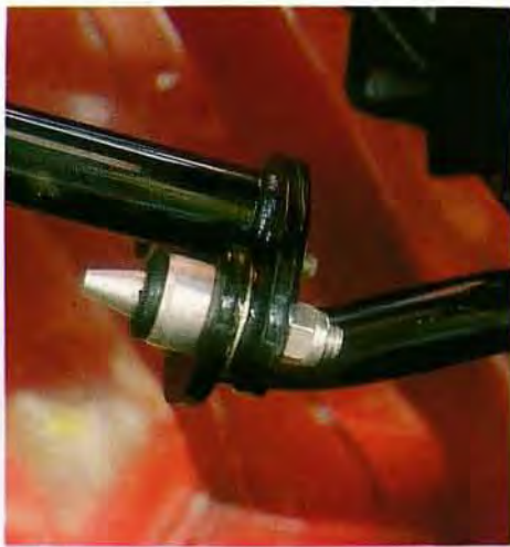
Rattstängan är av säkerhetstyp – delar sig vid deformation av bilens framparti.
