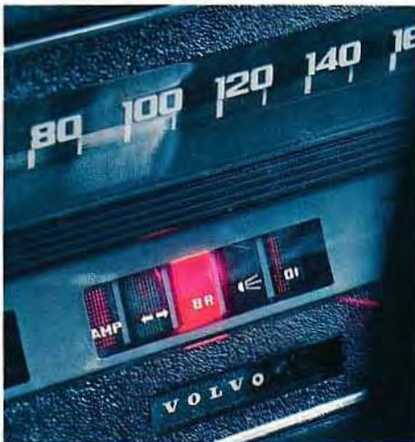
En varningslampa lyser när parkeringsbromsen är åtdragen eller om en bromskrets är ur funktion.
