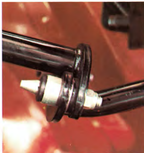
Rattstång av säkerhetstyp — delar sig vid deformation av bilens framparti.
