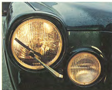
Halogenstrålkastare med torkare Volvo 164 E har fått en verkligt förnämlig ljusutrustning. Extra stora runda halogenstrålkastare ger ett utomordentligt ljusutbyte, och strålkastartorkare är numera standard.
