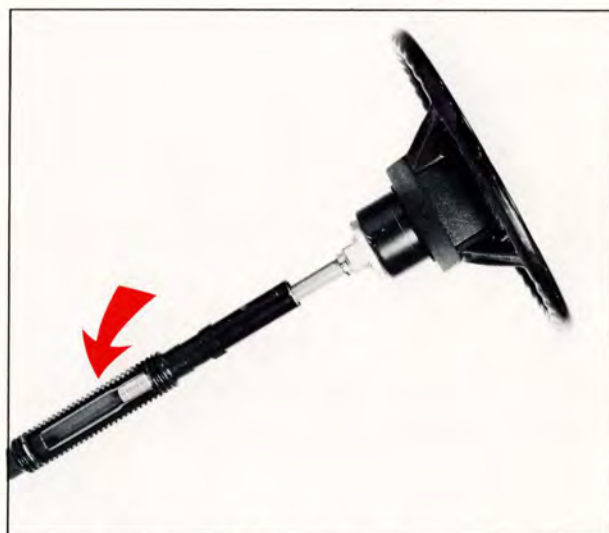
10. Rattstängens i Volvo 164 E har en teleskopdel som pressas ihop vid hård belastning. För att rattroret runt teleskopdelen inte skall hindra sammanpressningen har det fått bälghorm. Volvo 140-serien behåller sin tidigare typ av delad rattstäng men har dessutom fått teleskopdel och bälgrör.
