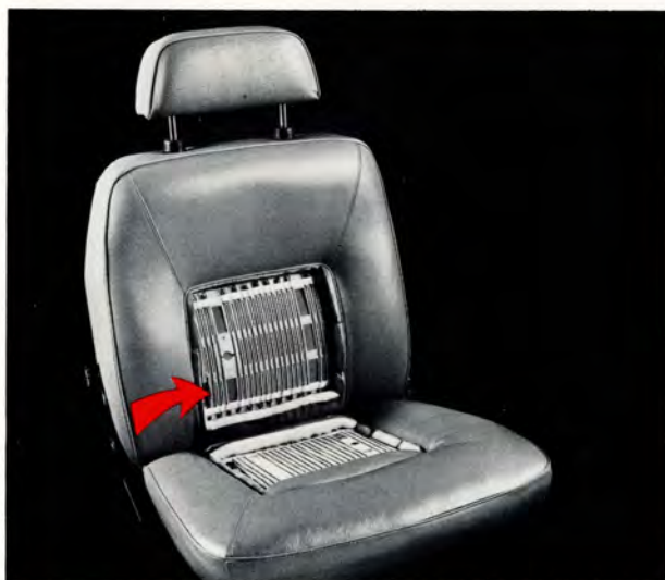
11. Förarstolen har fått inbyggda värmetrådar i både sits och rygg. Strömmen kopplas automatiskt på så snart stolstemperaturen är under +14^{\circ} (givetvis endast när tändningen är tillslagen). Den kopplas ifrån vid +26^{\circ} . Effekten är 2 \times 30 W. Det räcker för att värma stolen från 0^{\circ} till +26^{\circ} på tre minuter.
