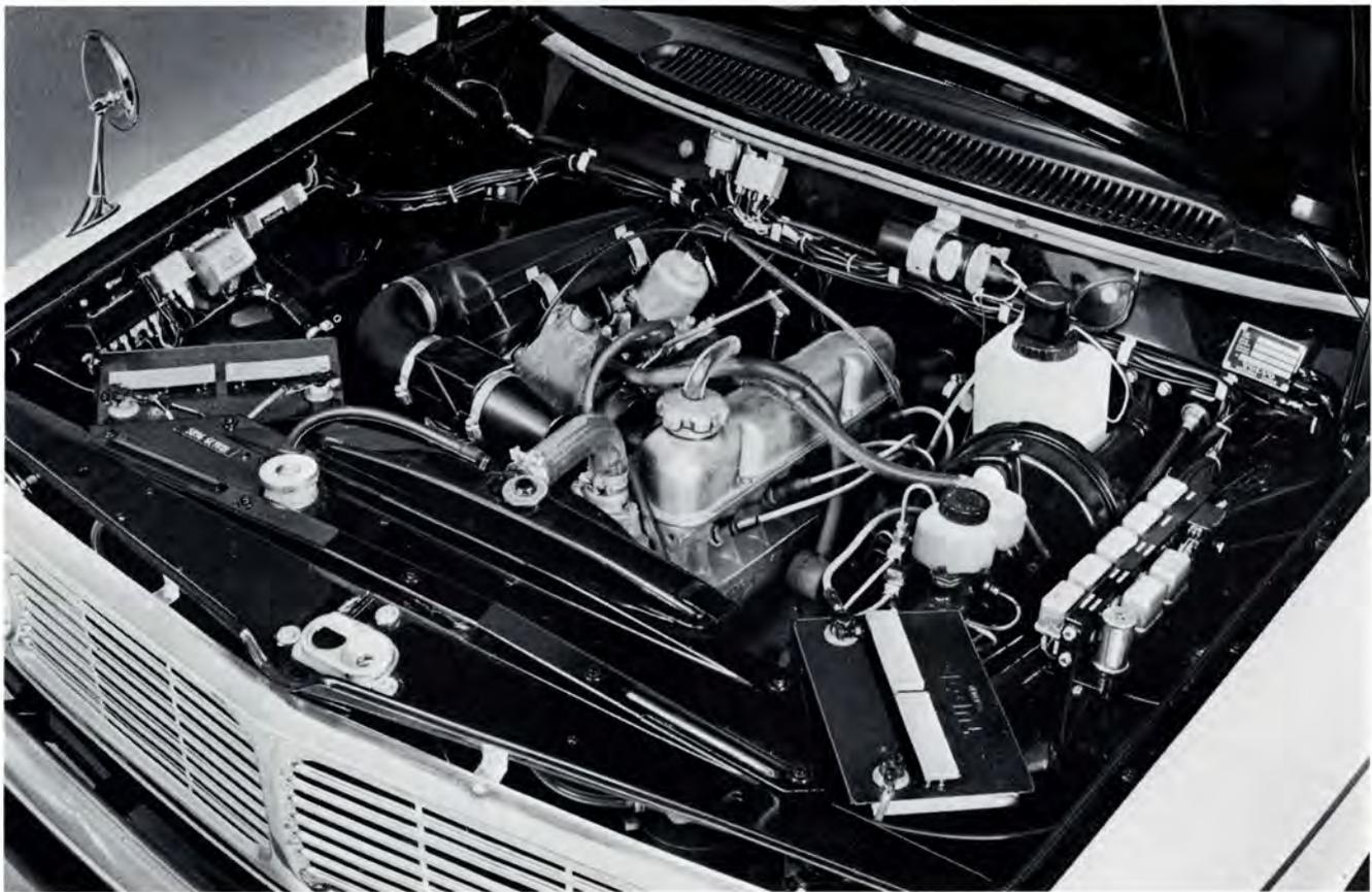
Die Volvo B20-Motoren. Vierzylinder. Zwei Liter Hubraum. Überdurchschnittliche Beschleunigung. Das hohe Drehmoment gewährleistet auch bei niedrigen Drehzahlen ein gutes Anzugsvermögen ohne große Schaltarbeit. Das ist besonders wertvoll im Stadtverkehr. Ruhiger, geräuscharmer Lauf. Thermostatgesteuerte Luftvorwärmung sorgt auch direkt nach einem
