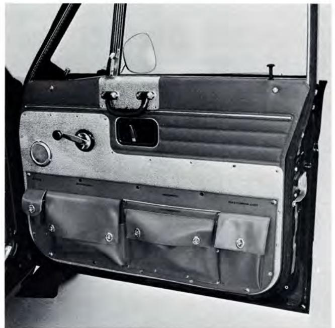
Die Türen sind mit Aluminiumblechen verstärkt. Die Taschen in den Türen können z.B. für weiße Manschetten, Stoppkellen, Fahrzeugmappen, Reifendruckmesser oder Werkzeuge benutzt werden. Sämtliche Türen sind mit herunterklappbaren Handgriffen versehen. Die Hintertüren haben Sperrvorrichtungen, deren Verriegelung vom Vordersitz aus bedient werden kann.
