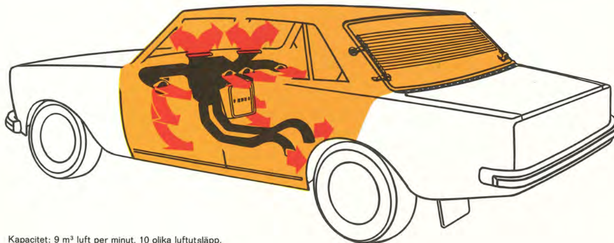
Kapacitet: 9 m 3 luft per minut. 10 olika luftutsläpp.
