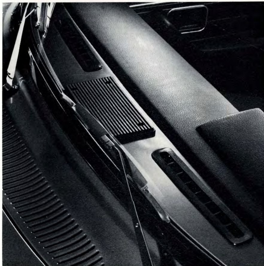
Reserverad plats för högtalare i främre delen av instrumentbrädans översida.
