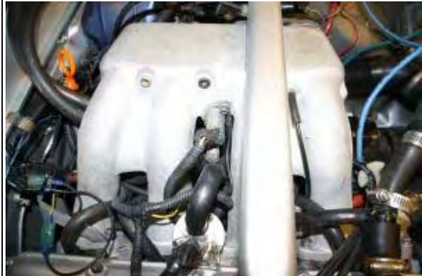
Kallstartsventilen i insugsröret. Under den syns tillsatsluftsliden.
