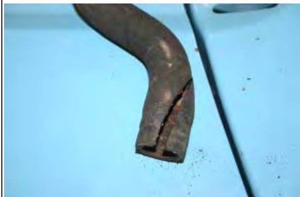
Ännu ett exempel på luftläckage, där ägaren garanterade att han hade kollat slangerna ordentligt. Sprickan doldes effektivt av slangklämman.
