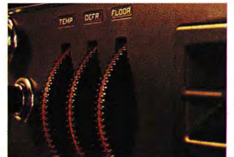
Belysta lättåtkomliga rattreglage för värme och friskluft.
