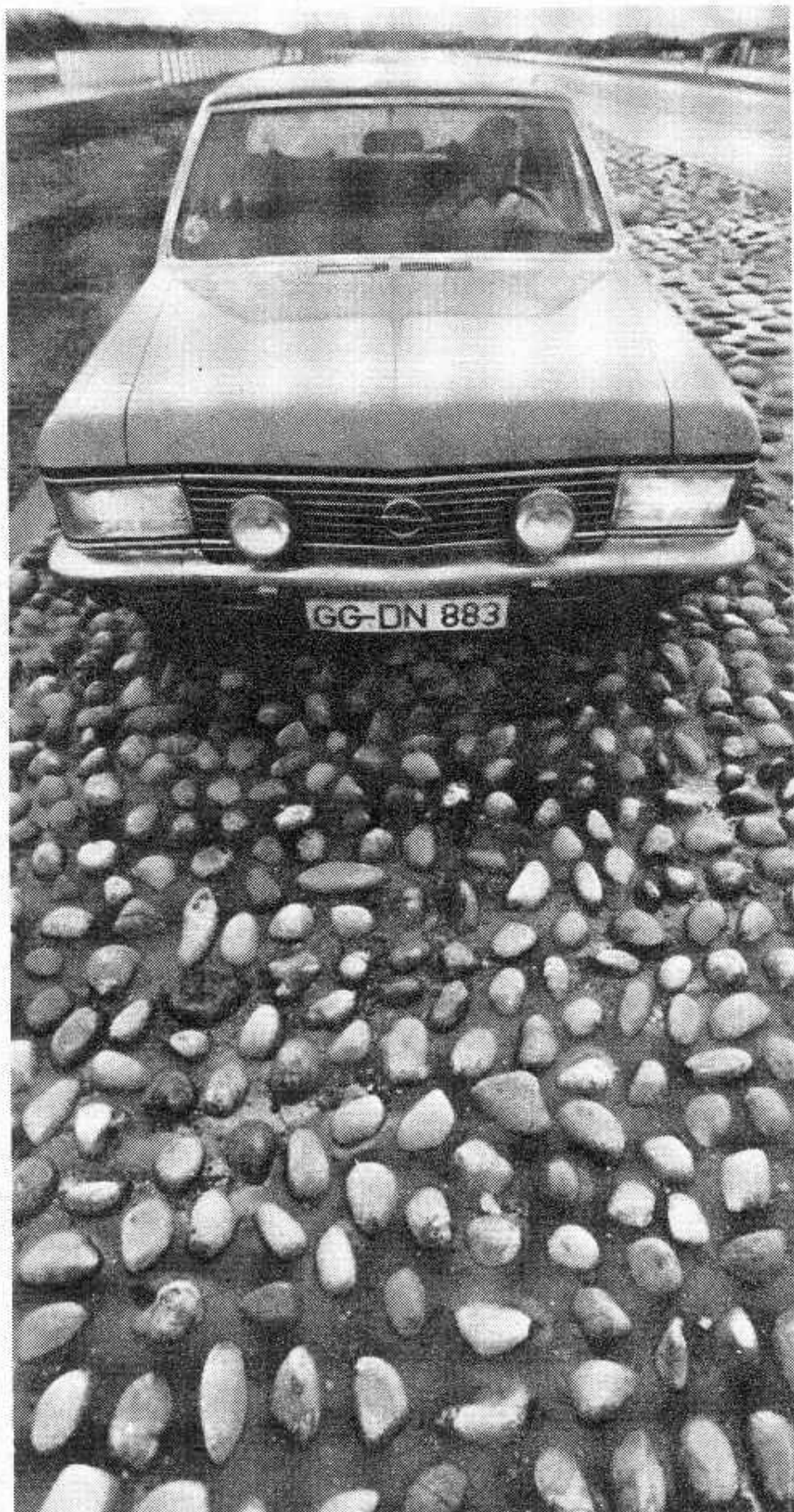
Opel Admiral: Mit aufwendiger DeDion-Hinterachse ausgezeichneter Federungskomfort auch auf der Holperstrecke
