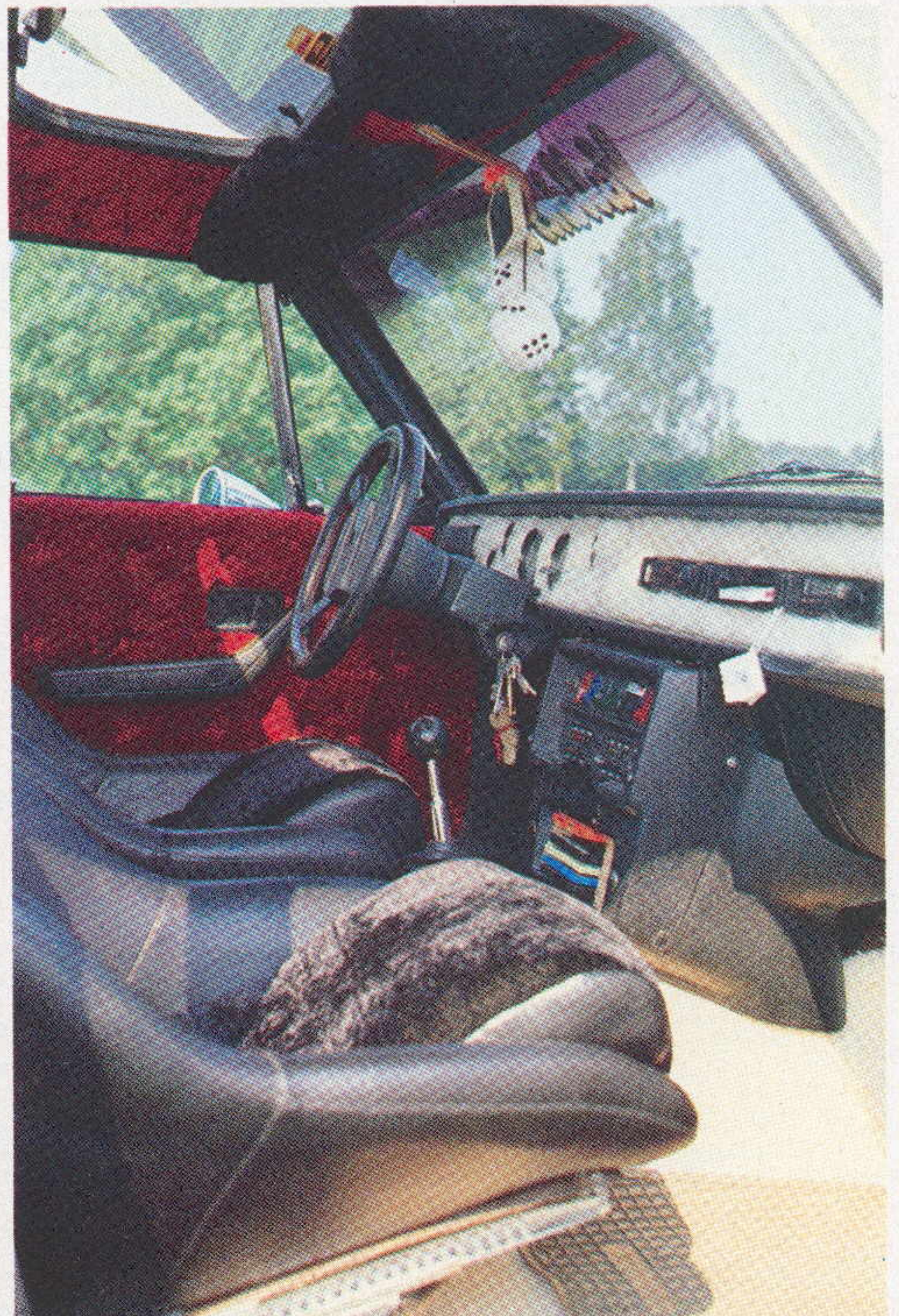
Inredningen har Bobby fixat själv. Krossad plysch, stolar från Comfort Racing samt fönsterhissar gjorda av vindrutetorkarmotorer.
