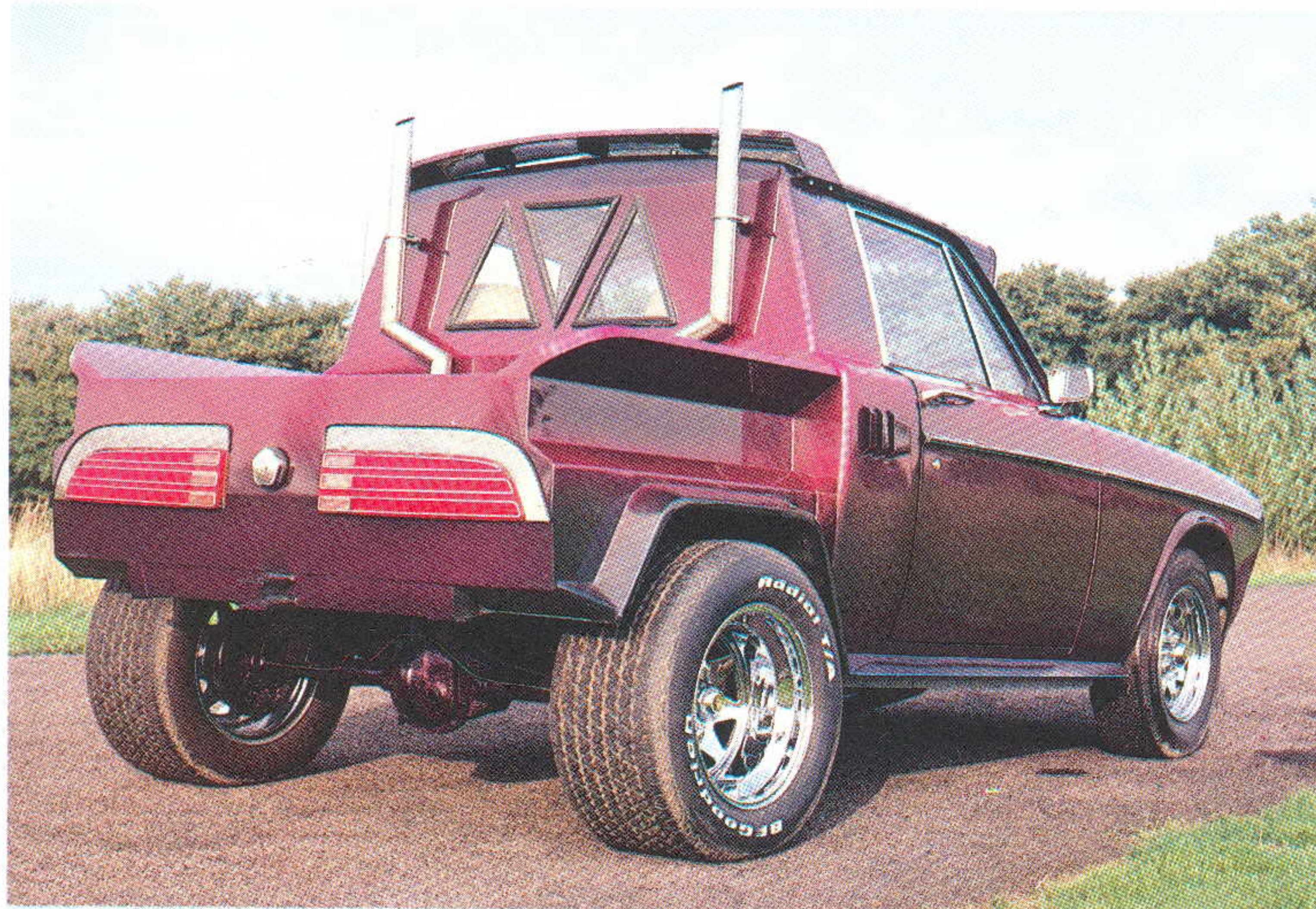
Dom vinklade rostfria rören är svetsade med en argonsvets. Sulorna bak på Crome Spoke-fälgar är 12 tum breda.
