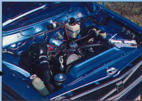
B20-motorn är strypt med fastsvetsade ringar i insugsröret. Styrsvot kommer från en Volvo 164.
