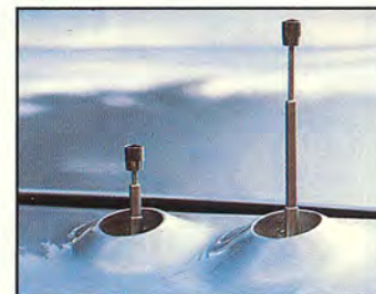
Dubbla elantenner finns nedsänkta i ena bakskärm.
