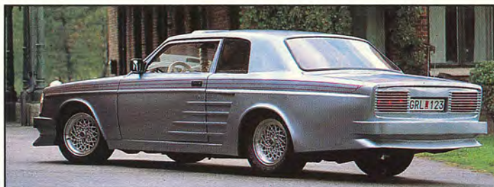
Bakre skärmkanterna är upplyftade för att kompensera den sänkta hjulupphängningen. Modifieringarna har utförts i olika steg under flera års tid.
