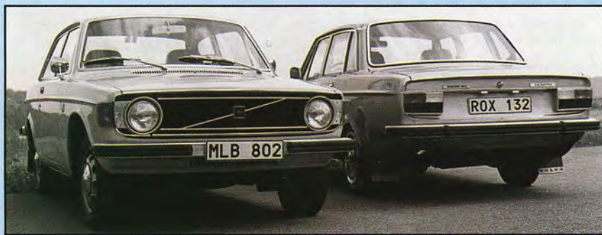
"LJUGARBÄNKEN". Överdimensionerade stötfångare på 1974 års Volvo 145 avsedd för den amerikanska marknaden. Rymlighet och förbättrad insprutning var det man trummade mest för. Och säkerheten förstås: ändrad placering av bränsletanken och förstärkta dörrar.
