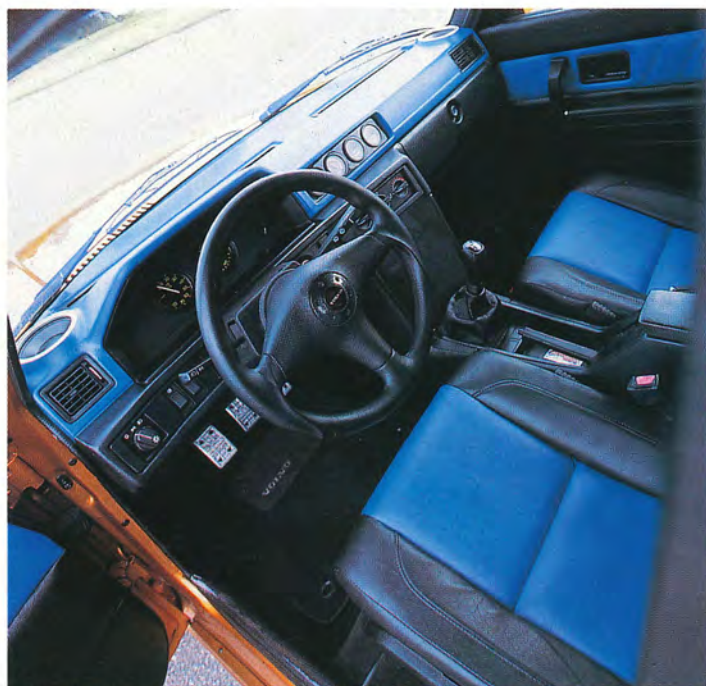
940-PANEL. Efter en släng av sågen gick det att klämma in den modernare instrumentpanelen. Hastighets- och varvräknaren från smått klassiska 242 GT sitter i en kolfiberpanel. Andra, mer oväsentliga Volvo-klockor är hänvisade mot höger.
