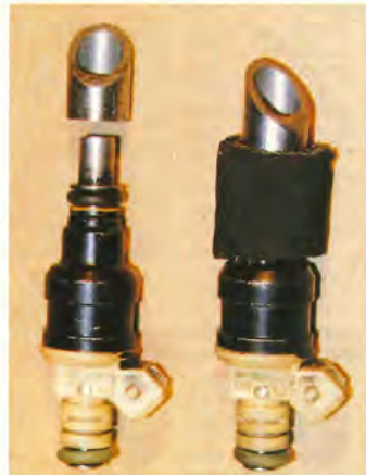
MONTERING. Ett enkelt sätt att montera elektroniska spidare — med slangklammer runt gummislangen sitter spidaren tillräckligt stadigt för uppåt 1 bars laddtryck.
