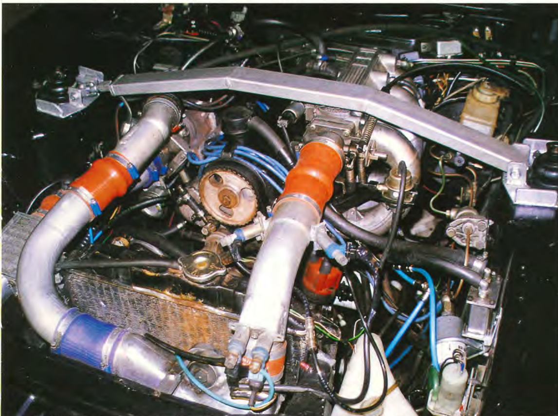
RESULTATET! Att motorrummet är ostädadt och fullt med slangar är en sak, men det fungerar i alla fall. Motor och insprutning kommer från Sierra, turbon från Volvo 850. Med 0,6 bar är den bromsad till 168 hk på hjulen.
