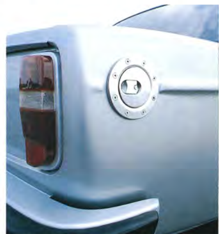
FÖRSÄNKTK. Originallocket fick lämna plats åt en betydligt rejsigare variant — i aluminium, naturligtvis!
