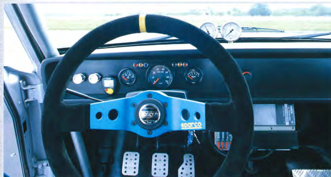
TRIVSELREDSKAP. Varvräknaren i centrum omgiven av de mätare som behövs. Reglagen i vänsterkant är svarvade ur aluminium med originalen som förebild.
