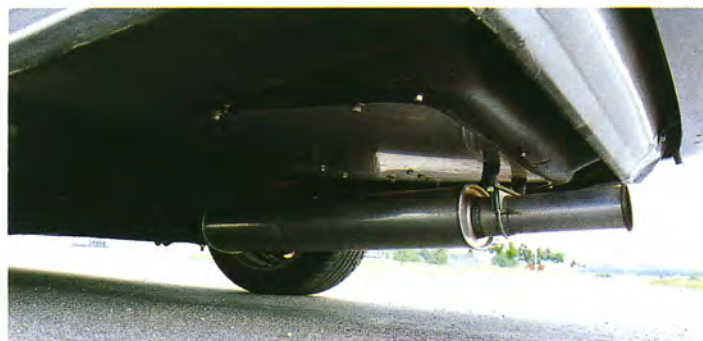
RAKA RÖR. Avgassystemet består av en egentillverkad tretumsvariant från turbon rakt ut till en Apple-dämpare.
