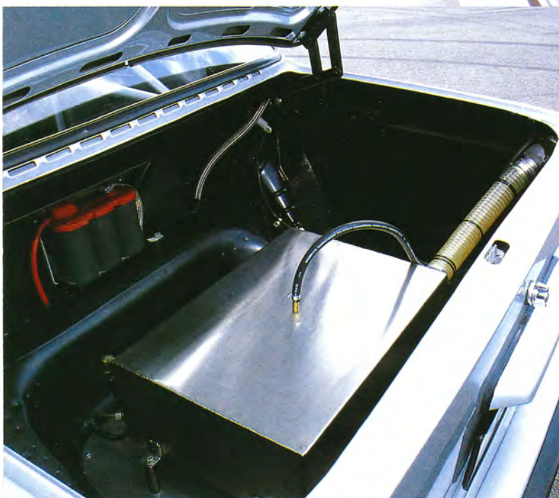
TANKFULLT. Batteri och hembyggd tank som rymmer 50 liter ger både grepp och tillräcklig aktionsradie.
