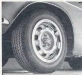
Däckstorleken på 1800 har ändrats till 185/70 HR 15. Däcken är monterade på 5,5 tumms fälg.
