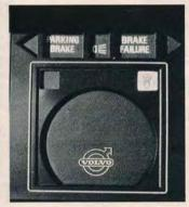
Nytt i instrumentpanelen är en lampa som varnar för ljusbortfall — »den tänds när lampan slocknar», dvs om halvljus, bakljus eller bromsljus inte fungerar perfekt. Framstolarnas infästning har förstärkts.
