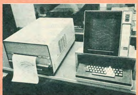
I de flesta provrum där hela bilar provas, finns rullande landsvägar så att man kan köra bilen under provet och simulera konditioner från bilens vardag. Flera provriggar är direktanslutna till datorn och där kan provaren få mätningar, beräkningar och diagram både utskrivna eller presenterade på en bildskärm.
