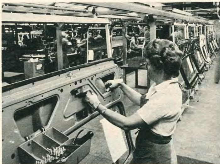
Förmontering av baddörren till stationsvagnen 145 är exempel på en detalj som brutits ut från själva monteringsbanan. En åtgärd som befrämjar arbetsmiljön
