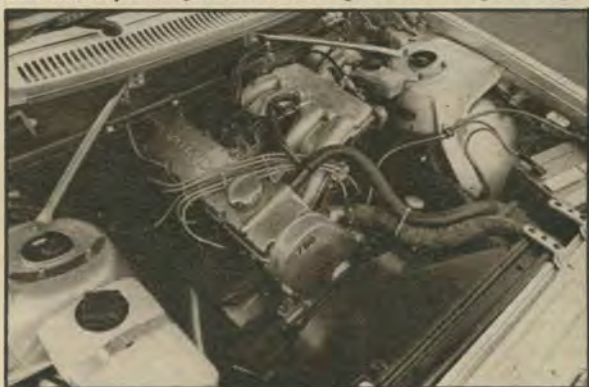
● B23E-motorn på 2 315 cm 3 och 140 hk är den stora förändringen på GT:n. 0 – 100 går på ca 10 sek.
