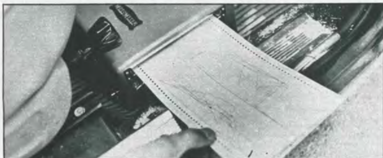
Kurvorna som visar bromseffekten och pedalkraften ritas ut direkt av mätapparaten i bilen.
