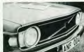
● Fronten hör till det som ändrats: är nu av plast.
