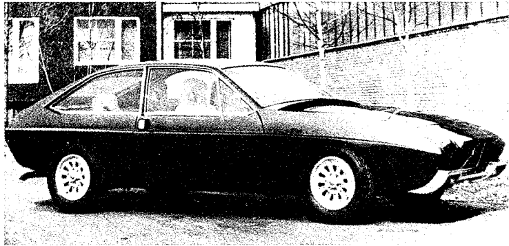
Dieser als Nachfolger des Volvo P 1800 gedachter Prototyp stammte von Zagato, basierte auf dem 164 und hatte auch schon einen Namen: »Volvo 3000 GTZ«.
