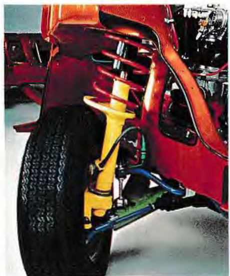
Den nya framvagnen är av fjäderbenstyp — en välkänd konstruktion, som Volvo nu vidareutvecklat.
