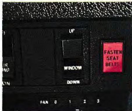
Elektriskt drivna fönsterhissar är standard på 264 GL och finns som tillbehör till övriga modeller.
