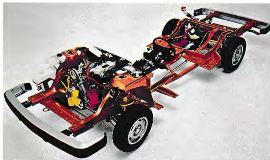
Styrningen av kuggstångstyp ger exaktare styrning samtidigt som vändradien i det närmaste är lika liten som tidigare. (4,9 m mot 4,8.)
