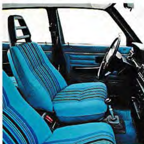
Stolarna har en styvare konstruktion, samt är fastare förankrade i golvet. Dom är enkelt höj- och sänkbara.
