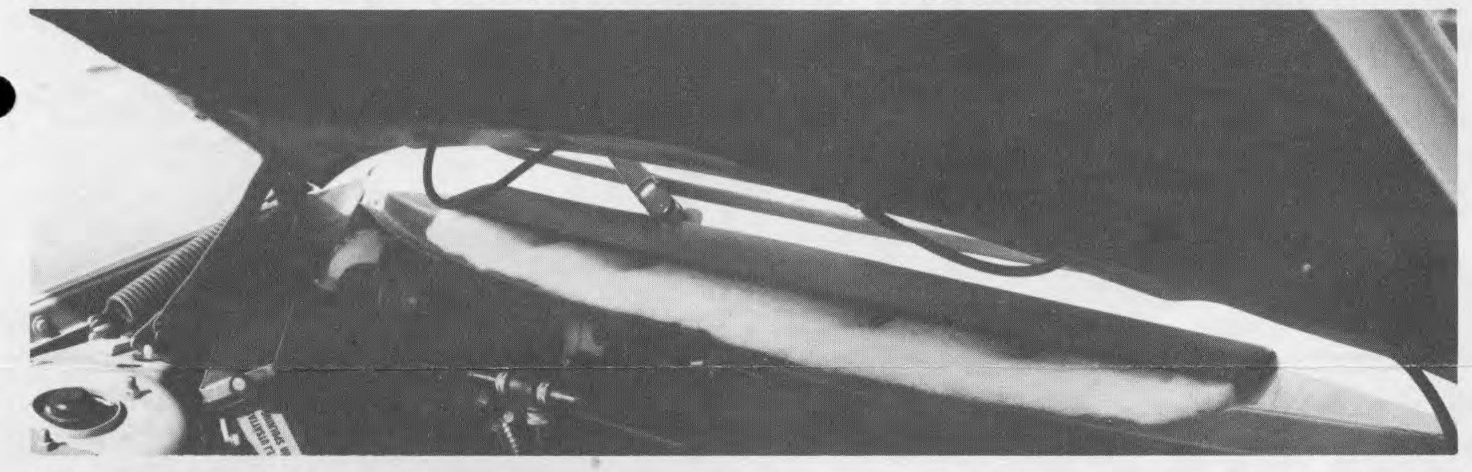
3 Öppna huven och stäng, filtret skall nu ligga i kläm mellan huv och torped. Kontrollera att filtret sluter tätt. När huven har varit öppnad och återigen skall stängas, kontrollera att filtret ligger på plats.
