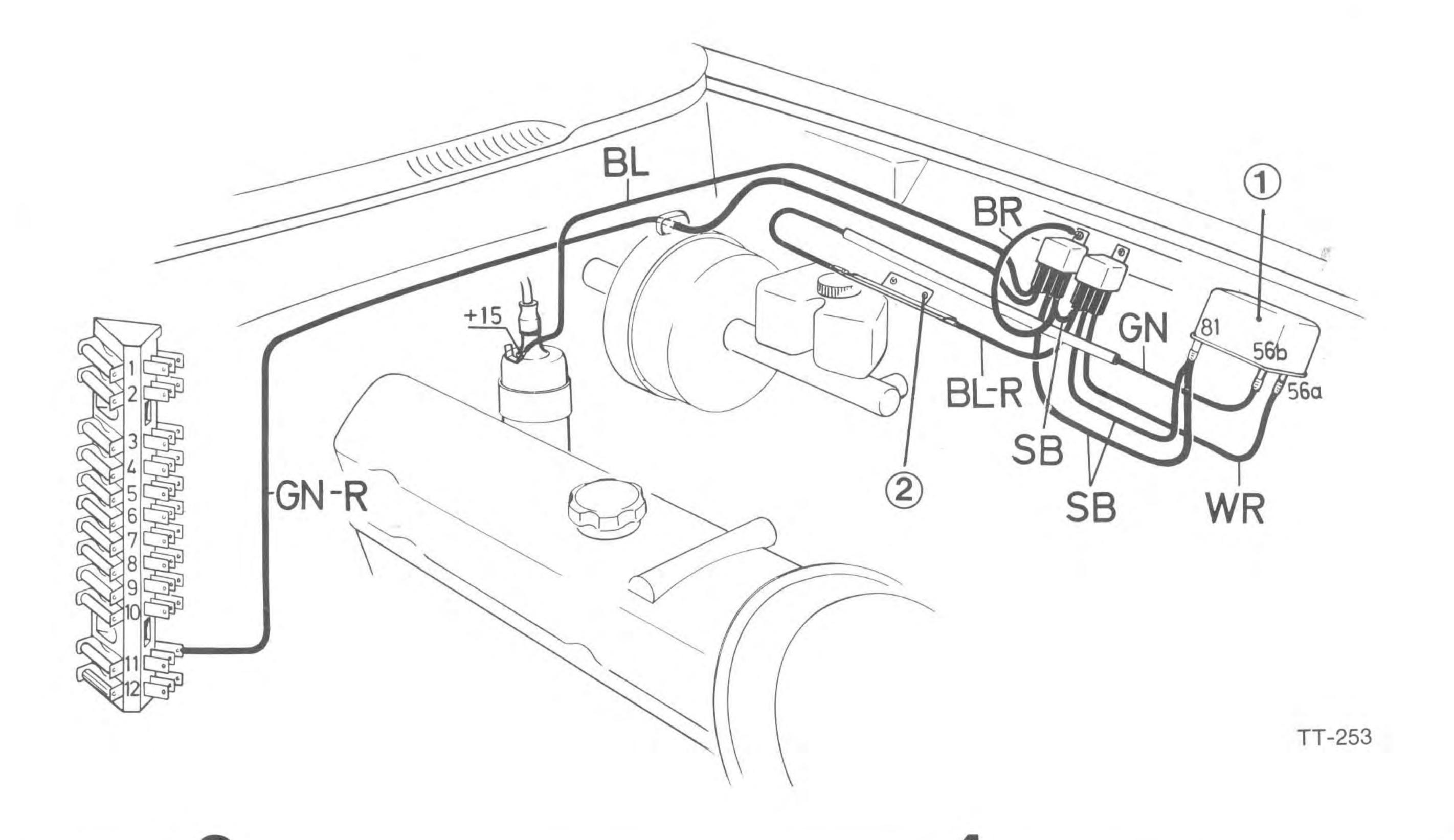
Anslut blå ledning till tändspolens anslutning 15 (+). Dra in grön/röd ledning på lämpligt ställe i kupén, lossa paneler och anslut till säkring nr 11 säkring för bakljus. Sätt tillbaka panelerna.
