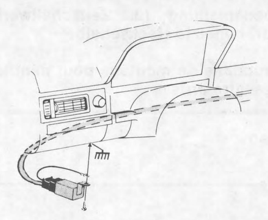
Borra hål, Ø 3,5 mm och sätt fast reläet. Ev. kan det sättas i ett redan befintligt hål.
