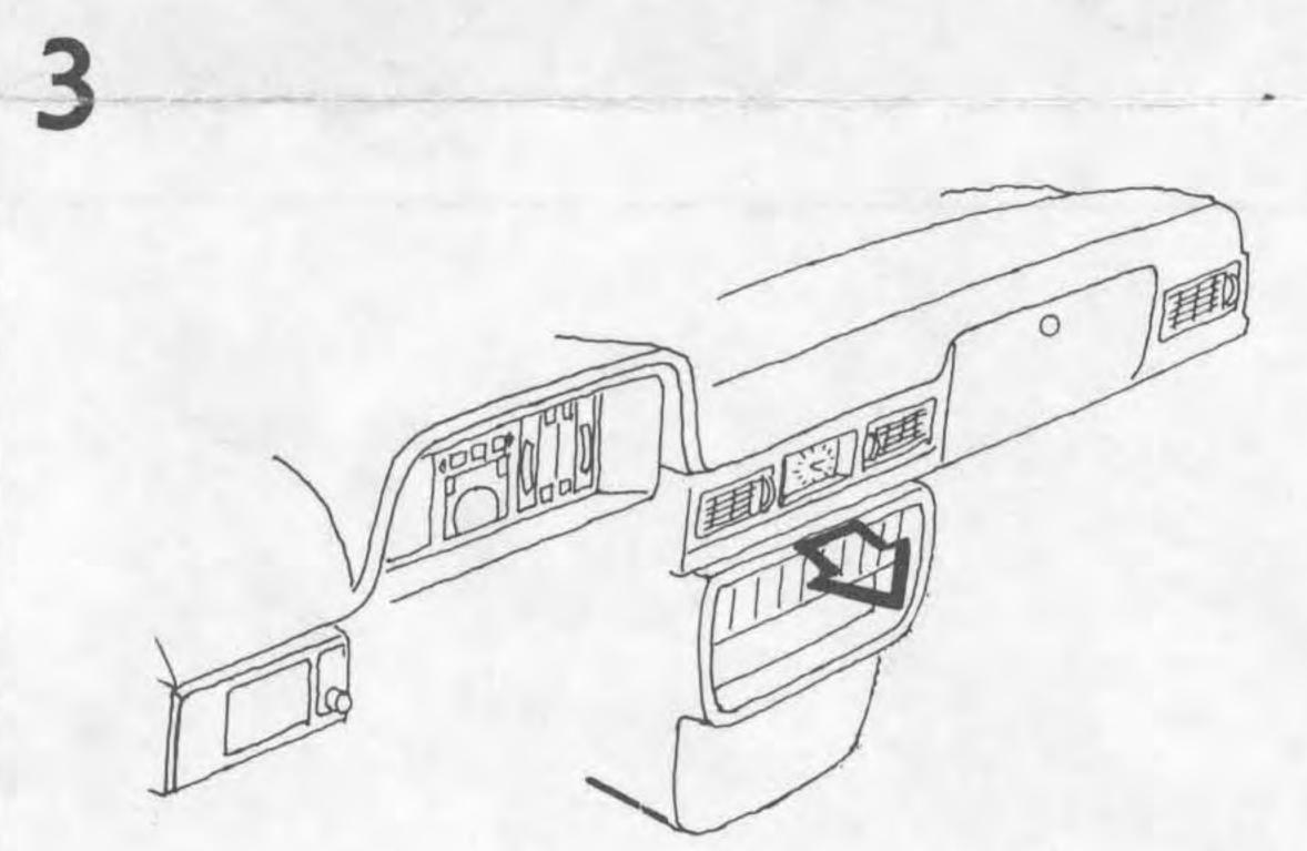
Vik ut panelen så långt ledningarna tillåter. Ev. radio bör lossas och dras ut något.
