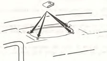
Montera plåtmutterna i kanten på högtalarhålet.
