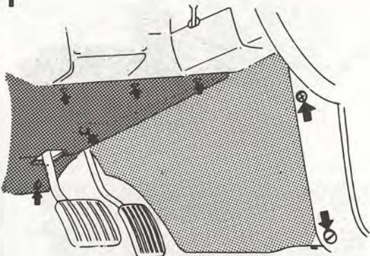
Lossa och vik ner isolerpanel under instrumentbrädan.
