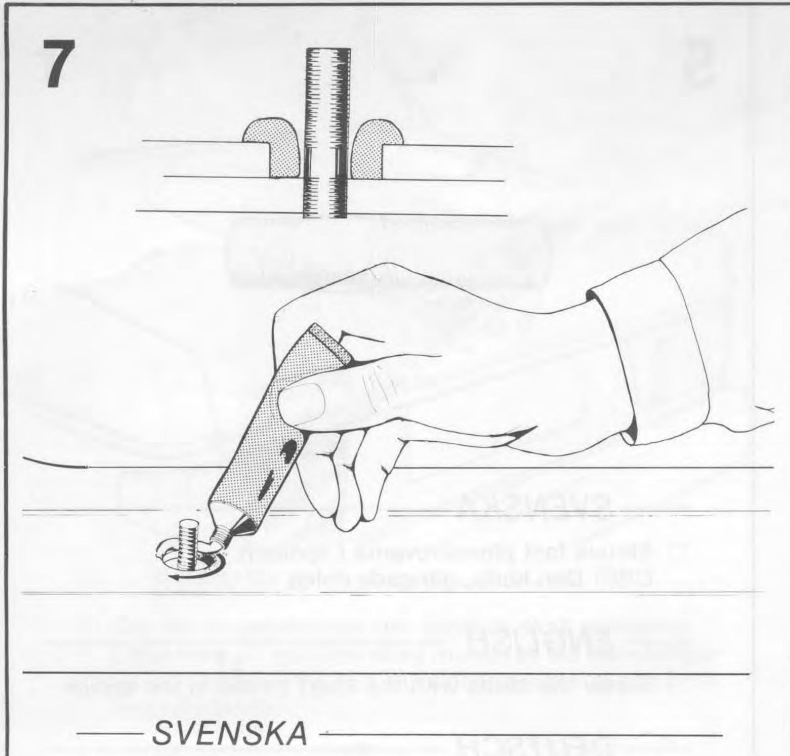
Applicera bifogad tätningsmassa runt pinnskruvarna
