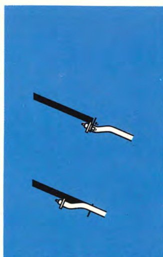
圧力を吸収するステアリング・コラム。体の圧力を平均に受ける可動式ステアリング、ホイール。
