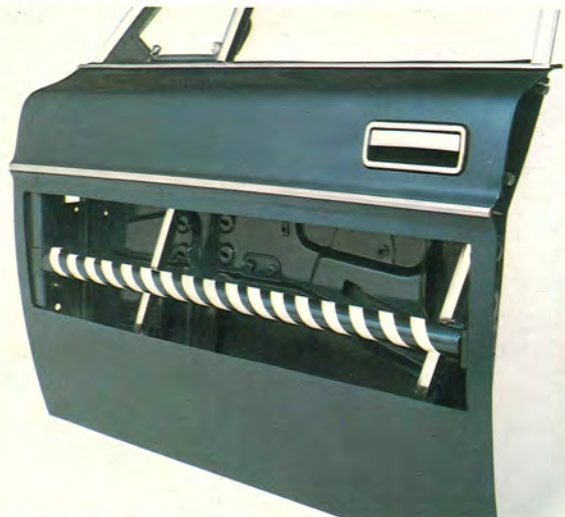
ドアにまでパイプ型の強化バー。側面からの衝撃にレジストします。
