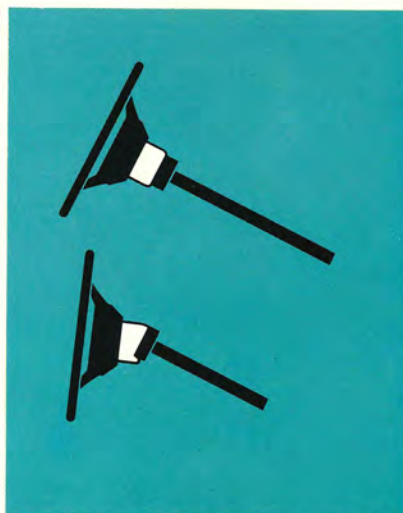
圧力を吸収するステアリング・コラム。体の圧力を平均に受ける可動式ステアリング、ホイール。
