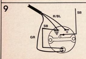
Anslut kablarna till instrumentet.
