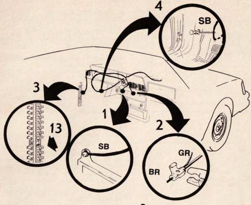
Anslut den svarta kabeln från instrumentet på mittpanelens jordningsskruv.
