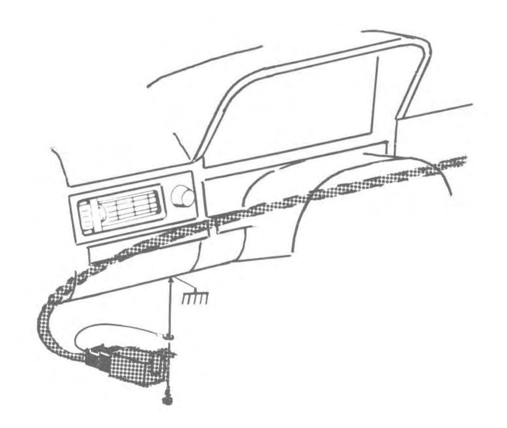
Borra hål, Ø 3,5 mm och sätt fast reläet. Ev. kan det sättas i ett redan befintligt hål.
