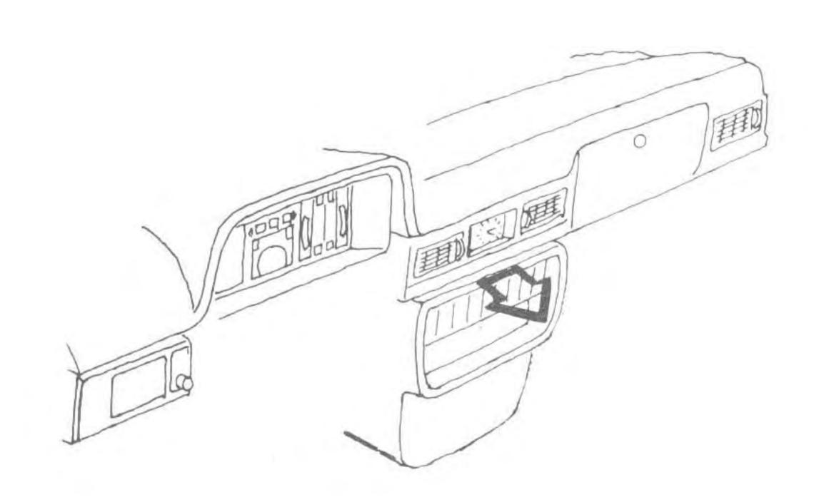
Vik ut panelen så långt ledningarna tillåter. Ev. radio bör lossas och dras ut något.
