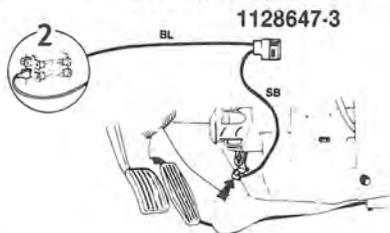
I bilar som saknar 2-poligt kontaktstycke monteras detta enligt bild.
