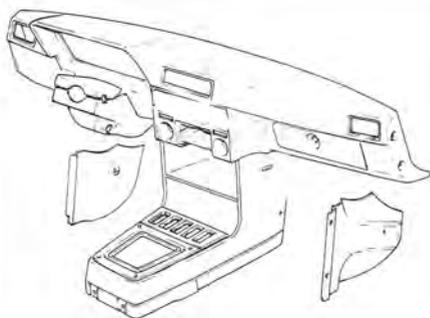
Ta bort panelerna på båda sidor om mittkonsolen.
