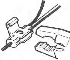
Klipp av kabelskon och anslut den svarta jordledningen till jord i vagnen med en "scotch-lock".
