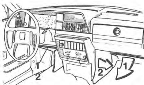
Lossa och vik ner isolerpaneler (1) på bägge sidor.
