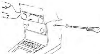
Skruva fast radion med bifogade fästskruvar på båda sidor.
