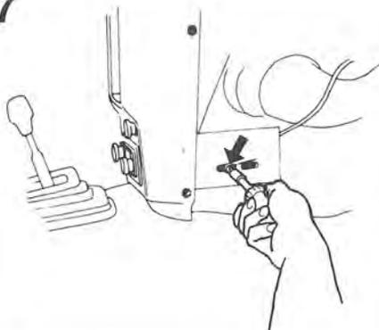
Skruva fast radion med bifogadé fästskruvar på båda sidor.
