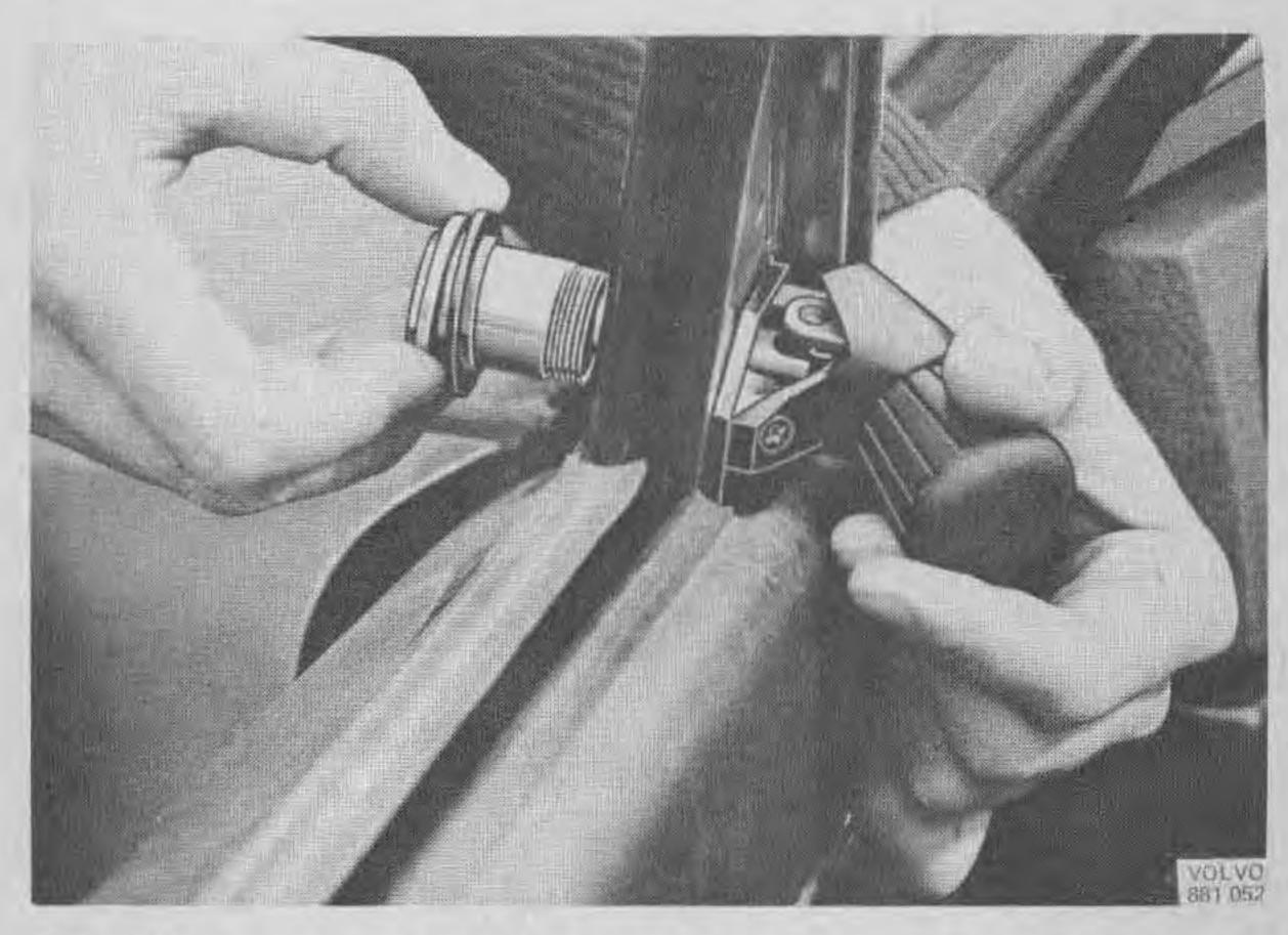
Montera manöverarmen med fäste i dörren. Styrbrickans fläns ska vara vänd mot dörren och med den plana kanten nedåt.
