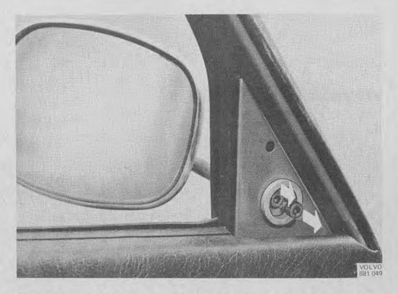
Demontera den gamla dörrbackspegeln (insex 5 mm). På vagnar utan dörrbackspegel ska den yttre prydnadsplåten bytas ut mot en med hål i (detaljnummer: v-sida 1213663-6, h-sida 1213664-4).
