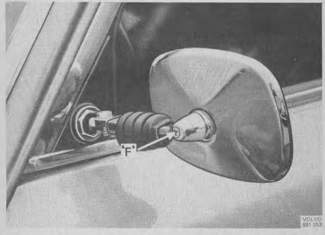
Montera spegelarmen till manöverarmen med låsskruven. (Plastbricka mot skruvskalle och kopparbricka mellan spegelarm och manöverarm.)
