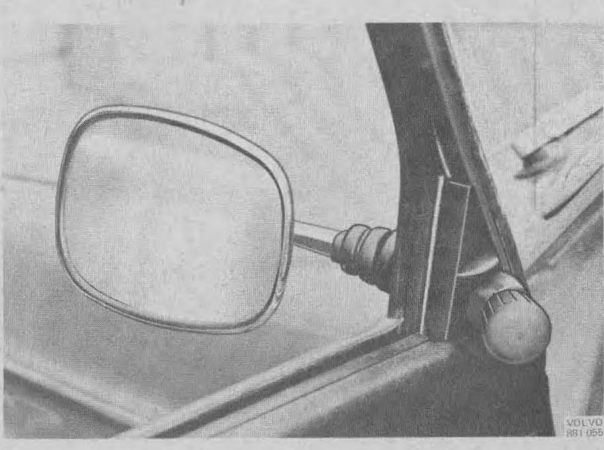
Dra av skyddstejpen och montera täckpanelen, tappen på täckpanelen ska pressas in i hålet i dörrbågstriangeln. (Tappen pressas lättast in om den först smörjs med tvållösning.)
