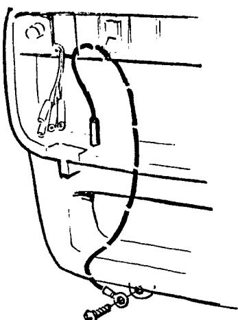
Montera den bruna kabeln med ringsko på en av skruvarna som håller stativet för reglagepanelen och fram till urtaget.
