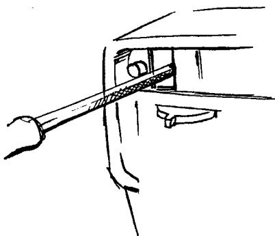
Fila ett urtag i panelen så att knappen går igenom och tryck fast täckbrickan.
