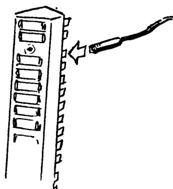
Montera strömförande kabel till säkring nr 3.
