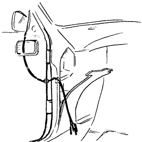
Drag kabeln genom befintliga gummigenomföringar i dörr och A-stolpe i kupén.
