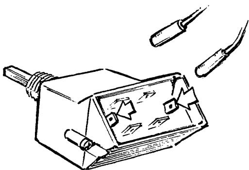
Montera strömförande kabel (röd) och jordkabel (brun) på de två yttre stiftarna på reglageknappen.
