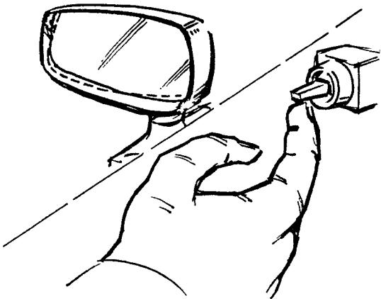
Prova spegeln. Vrid reglageknappen i täckbrickan tills rätt läge på spegel och knapp överensstämmer, dvs om knappen trycks utåt skall spegeln gå utåt.
