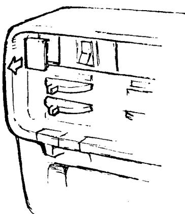
Drag fram reglagepanelen och tryck ut en täckbricka.
