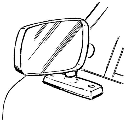
Drag fast spegeln med skruv, bricka och mutter.
