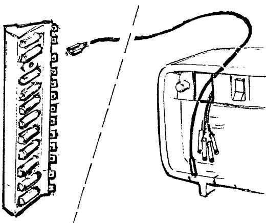
Drag den röda kabeln från säkringsdosan och fram till urtaget.
