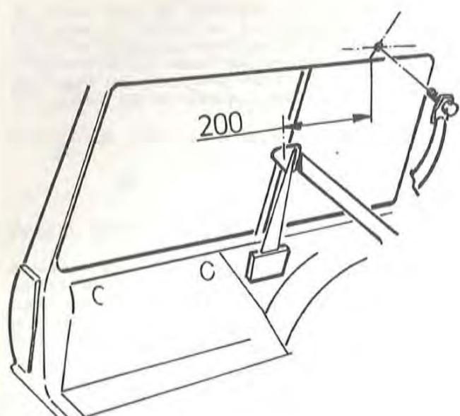
Lokalisera hål för bältets övre fästpunkt. Gör försiktigt hål i innertaket och skruva fast bältet. Åtdragningsmoment: 20 - 40 Nm (2 - 4 kpm)
