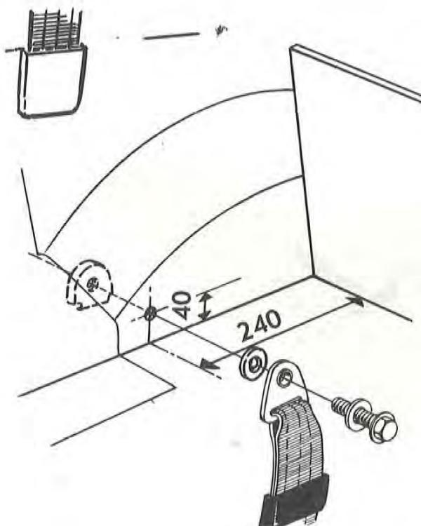
Borra hål i hjulhusen enl. figur Ø 11,5 mm och sätt fast säkerhetsbältena. OBS. Änden med justeranordningen skall monteras här. Åtdragningsmoment: 20 - 40 Nm (2 - 4 kpm).
