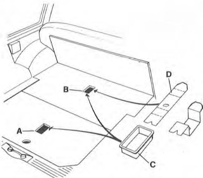
Lokalisera hålen (A och B) under mattan. Skär med en vass kniv ren hålen. Klipp ut och vik mallen (D) som finns längst bak i anvisningen och placera den i hål B och borra Ø 12 mm. OBS! Borra försiktigt då bensintanken är monterad på undersidan. Sätt dit plastskoningarna (C).
