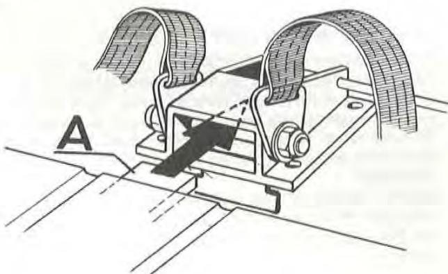
Placera extrasätet på luckan. Stick in sittdynans låsklack (A) i låset och skruva därefter fast sätet i hålen med mässingsbussningar.
