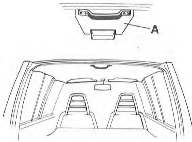
Montera instegshandtaget. Placera mallen (A) mot taklampan, märk ut och borra upp de fyra hålen. Skjut täckbrickan åt sidan och skruva fast instegshandtaget. Skjut tillbaka täckbrickan över skruvarna.
