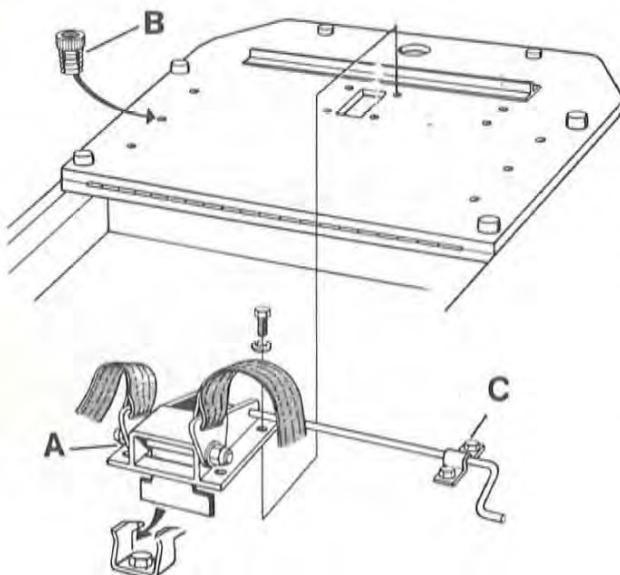
Fäll upp luckan helt. Slå med en hammare i de 12 mässingsbussningarna (B) i de förborrade hålen. Fäst låset (A) och vridstången (C) löst. Kontrollera att spärren går i läs och drag åt skruvarna. Låset är justerbart i sidled.
