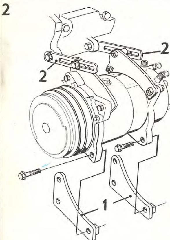
Sätt fast konsolen i satsen på samma plats som den nyss borttagna servokonsolen. Montera konsoler 1 och spännejärn 2 kompressorn. Sätt fast kompressorn i konsolen (4 skruvar).
