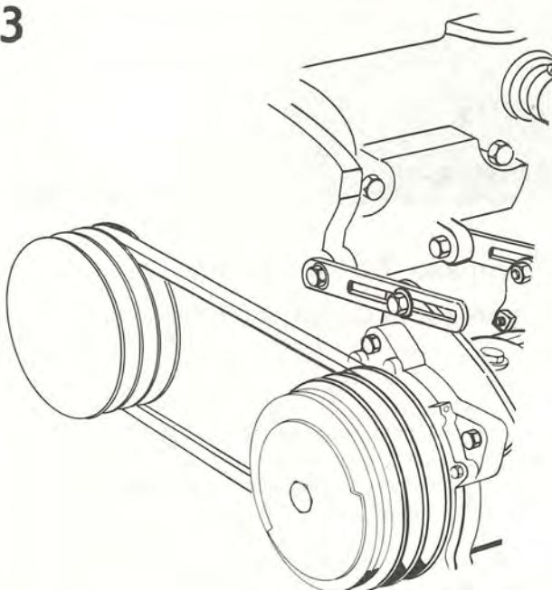
Slacka och lyft av motorns kilremmar. Montera kompressorns kilrem i det innersta spåret. Sätt tillbaka remmarna, spänn, och dra fast kompressorn ordentligt.
