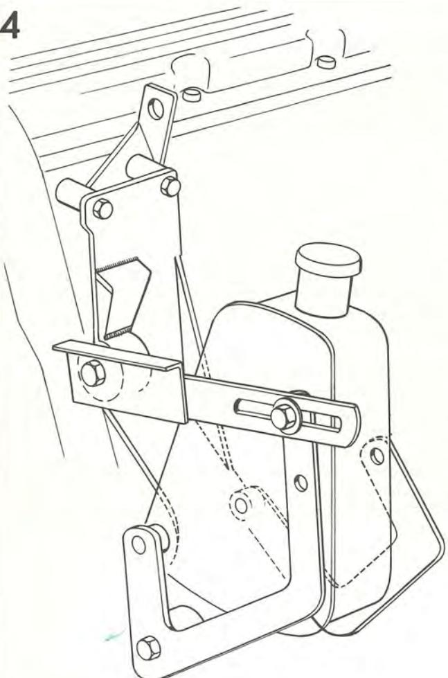
Ta bort den gamla konsolen från servopumpen. Sätt ihop den nya konsolen och skruva fast i samma fästpunkter som för lyftöglan.
