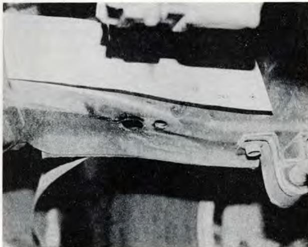
Klipp ur och placera mallen på balken. Märk ut för hålen och borra Ø 4,5 mm.
