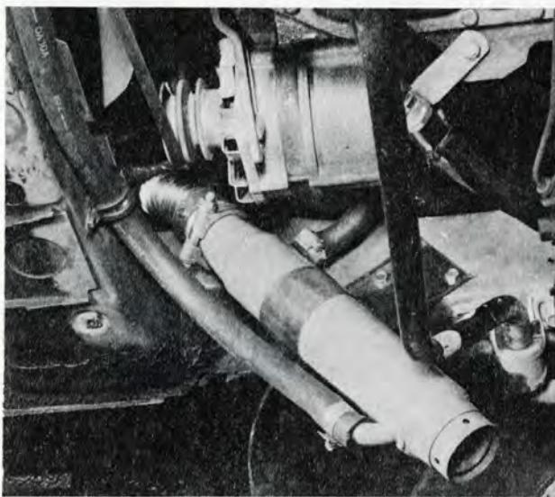
Den korta slangen ansluts till värmeväxlarens övre anslutning och dras upp mot övre kylarslang. Den långa slangen ansluts till den nedre anslutningen, klamas enl. bild, och dras mellan servoslang och batterikabel upp på motorns vänstra sida.
