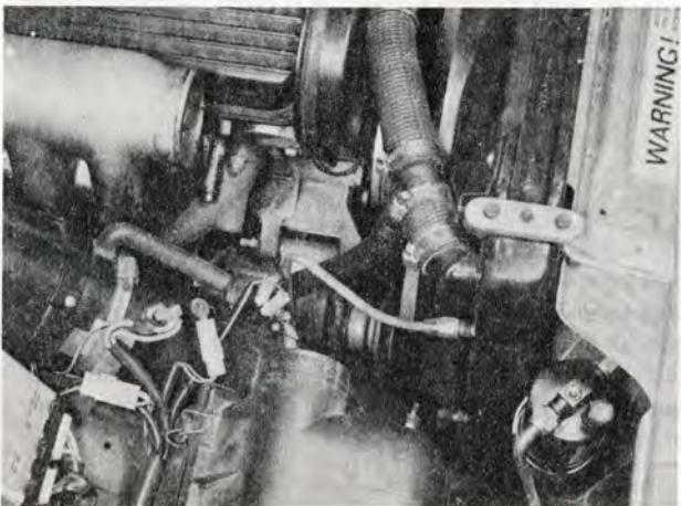
Skär av den övre kylarslangen och montera T-stycket med backventil.
