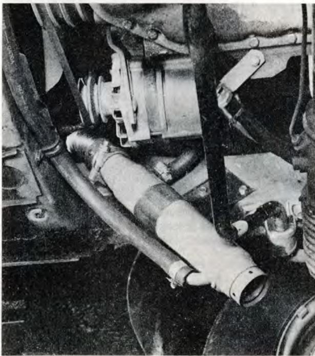
Trä på fästekonsolen på värmeväxlaren utan att dra åt. Sätt fast skarvröret, den smalaste delen på värmeväxlaren och dra åt klamman. Sätt fast avgasröret med plåtskruv. Sätt dit rörkrök med klamma och kontrollera att värmeväxlaren ansluter till värmaren. Dra åt klamman och skruva fast värmeväxlaren.
