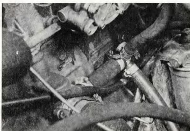
Ta bort det befintliga T-stycket i slangen från termostathuset. Montera det dubbla T-stycket i satsen. Här anslutes den långa slangen från värmeväxlaren.
