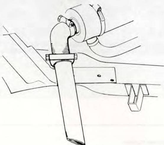
Ta bort skyddsplåten under motorn och värmarens avgasrör. Tappa ur kylvätskan och lossa undre slangens till kallstartsventilen.
