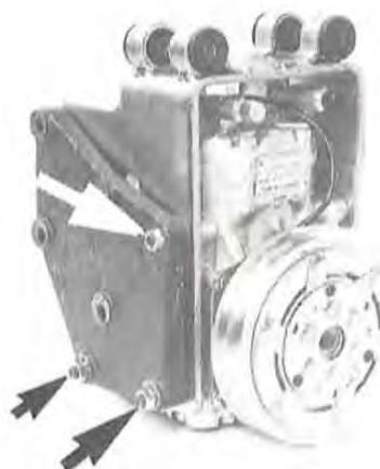
Montera kompressor med konsol på fästplattan (övre bilden visar fästplattan losstagen från motorn). Jordledning fästes i bakre, övre skruv (1).
