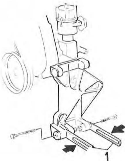
Sätt fast spännejärnen (1) på konsolen. Skruva fast konsolen på motorn.
