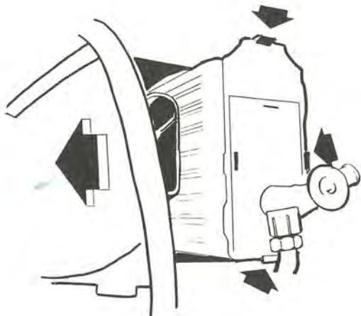
Sätt förångare på plats i bilvärmaren och fäst locket med tre clips.
