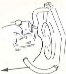
Lossa nedre kylarslangen från motorns vattenpump.
