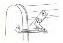
Sätt fast konsolen för slangarna på framkanten av motorn.
