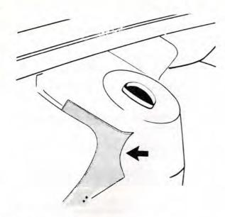
Klipp ur och placera mall I på hjulhustornet. Märk och borra 2 hål, Ø 4,5 mm. Sätt fast värmarens övre konsol. Lossa generatorns plusledning och klamma. Klipp ut og plasser mal I på hjulhustårnet.
