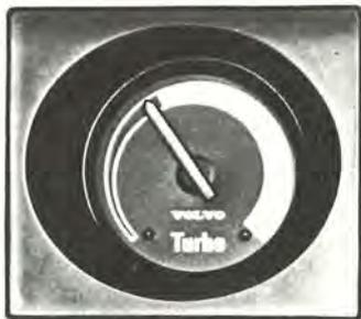
Laddningstryckmätarens skala är uppdelad i tre fält. Med visaren i det svarta fältet arbetar motorn som sugmotor. Detta fält är ett ekonomiområde. Med visaren i det gula fältet är turbon inkopplad. Om visaren kommer in i det röda fältet är övertrycket i insugningsröret för högt. Kör bilen försiktigt till verkstad för kontroll.
