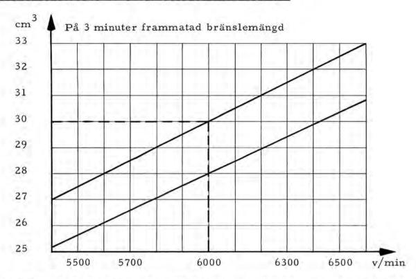
För att inte skada 0-ringen på ventilstyrningen, så fuktar man denna med bensin, varefter man skruvar in styrningen så långt tills man nått det på skissen angivna avståndet = 16 mm. Doseringspumpen monteras i bilen utan respektive skyddskåpor, för att man skall kunna kontrollera och ställa in bränslemängden när pumpen har den placering i förhållande till bränsletanken som den normalt skall arbeta under.
