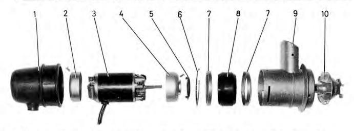
OBS! Vid arbete med fläkten får axeln inte utsättas för större belastning än 500 gr. Högre belastning eller slag skadar axelns lager.
