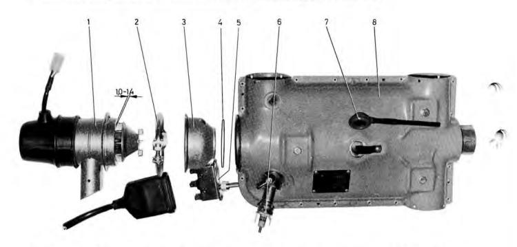
Samtliga elektriska ledningsanslutningar från termoströmbrytaren (5), glödstift (6) och förbränningsluftfläkten (1) bortmonteras. Överhettningsskyddet (7) demonteras från värmeväxlaren.
