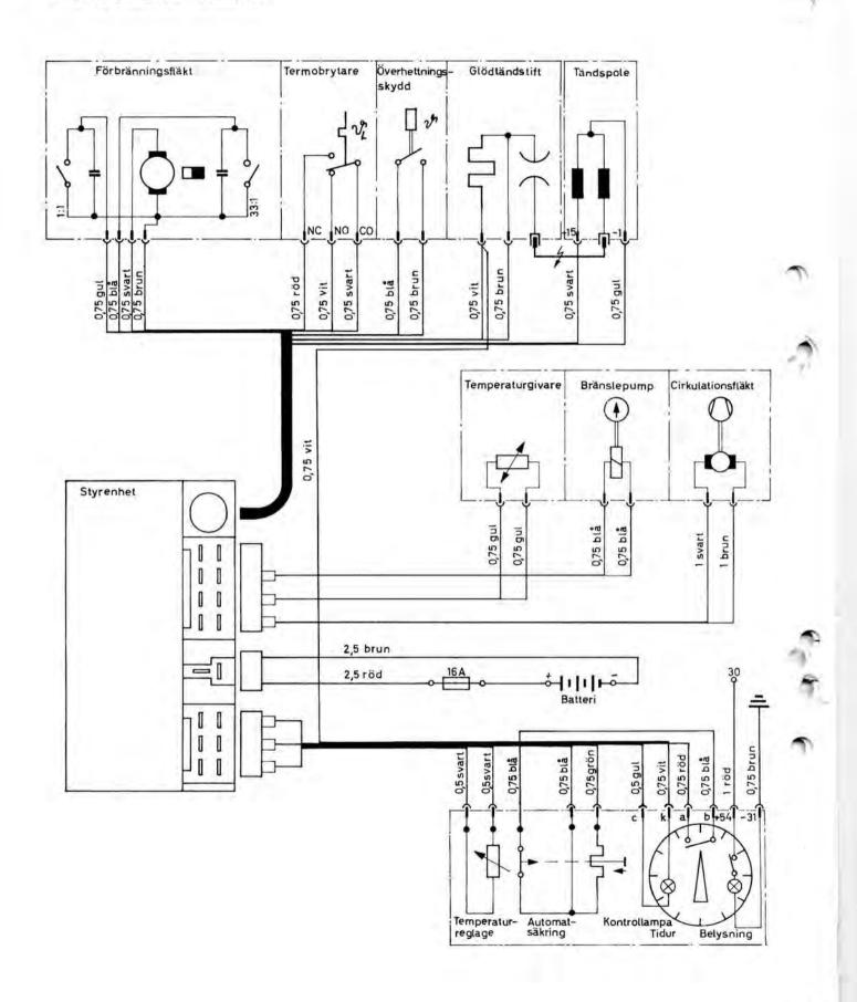
Det elektroniska styrreläet innehåller två stycken reläer och olika elektroniska komponenter (framgår ej av kopplingsschemat) för reläernas funktion.
